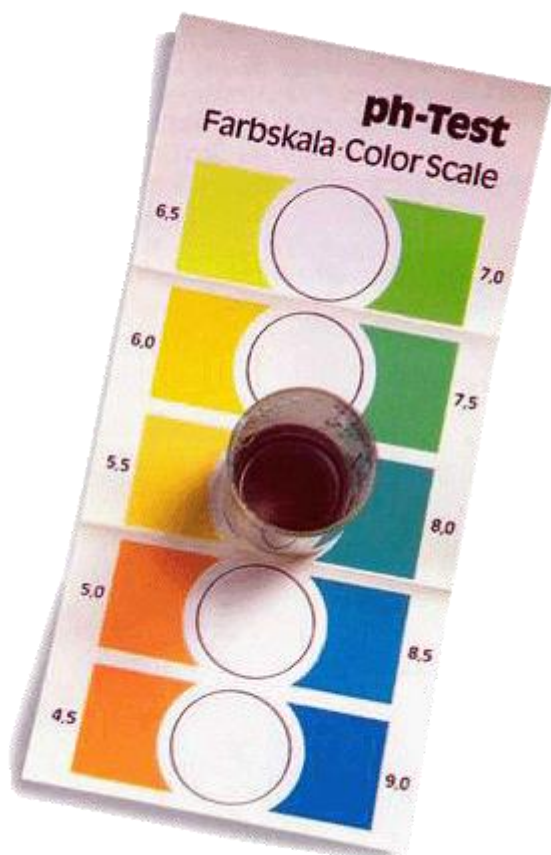
Рис. 2. Простейший цветной рН-тест, используемый аквариумистами
