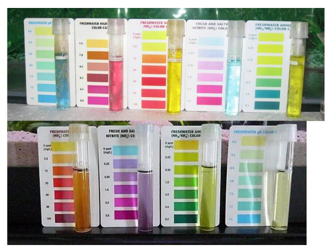
Рис. 3. Колориметрически-различные тесты на разные дескрипторы состояния воды
